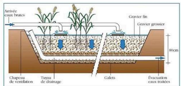
Coupe de principe d'un filtre planté de roseaux
